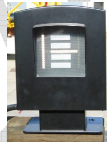
Deviatoio disposto per le provenienze dal ramo di sinistra - Impercorribile ramo destro
