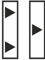
In precedenza ai Location Marker identificanti la fine sezione di blocco in linea.
