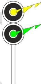
Via libera. Preavvisa inoltre un successivo segnale a via libera per un itinerario da percorrersi a velocità non superiore a 60 km/h.
